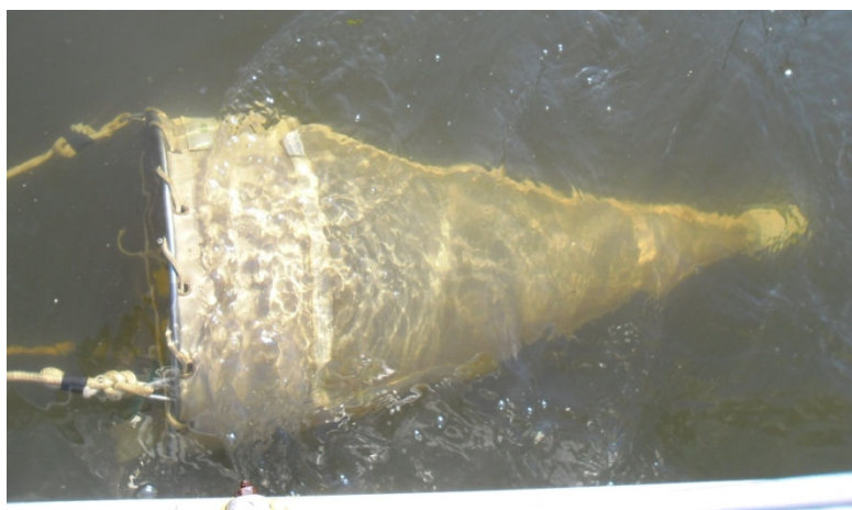
Figura 8.2.2.1.1.3-1. Rede cilíndrico-cônica com malha de 330 µm utilizada para coleta de larvas de peixes durante a campanha de setembro de 2012.
